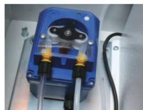
Microdosaggio di precisione regolabile su tutti i modelli.
